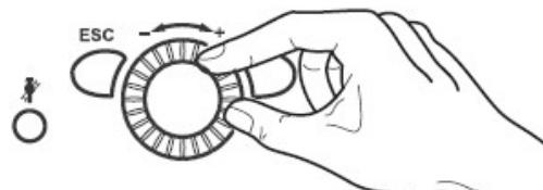
Задать желаемую температуру окружающей среды при помощи рукоятки блока управления и регулировки.
