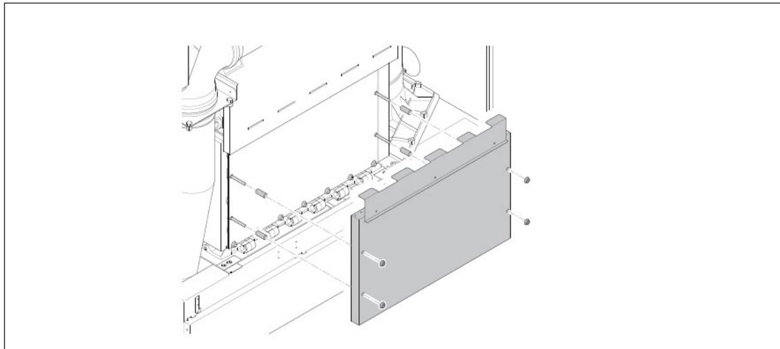
2. Ослабить гайки и снять изоляционную пластину с распорными втулками
