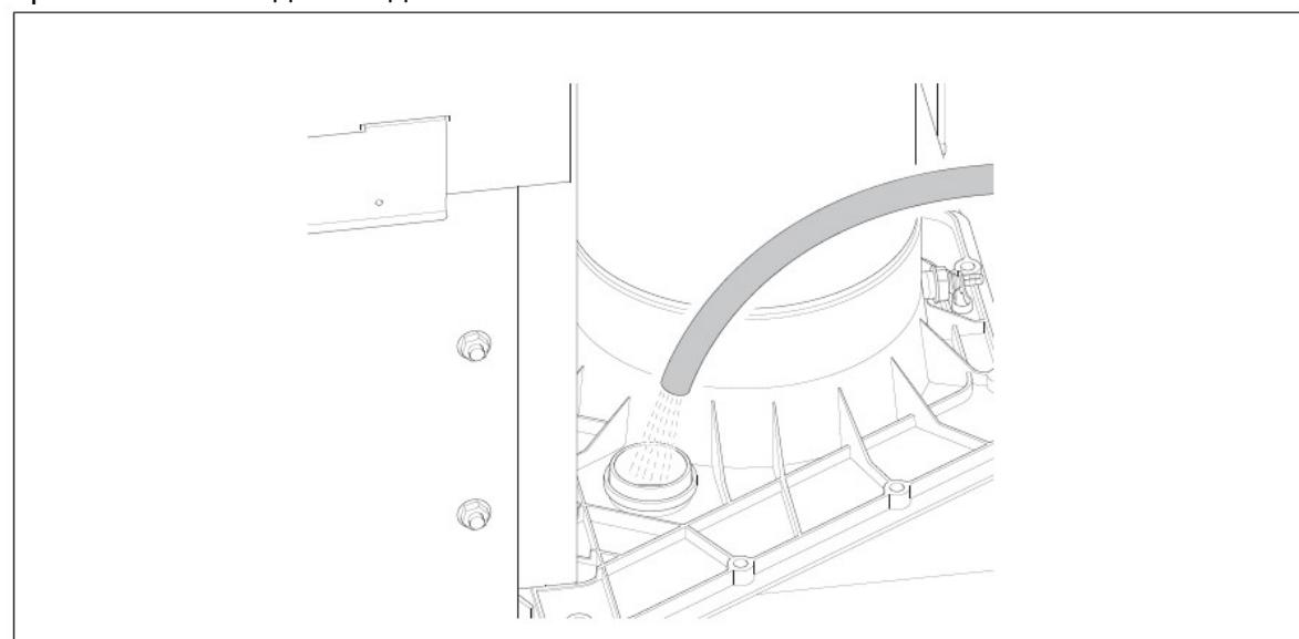
11. Через отверстие промыть водой ванну для конденсата
