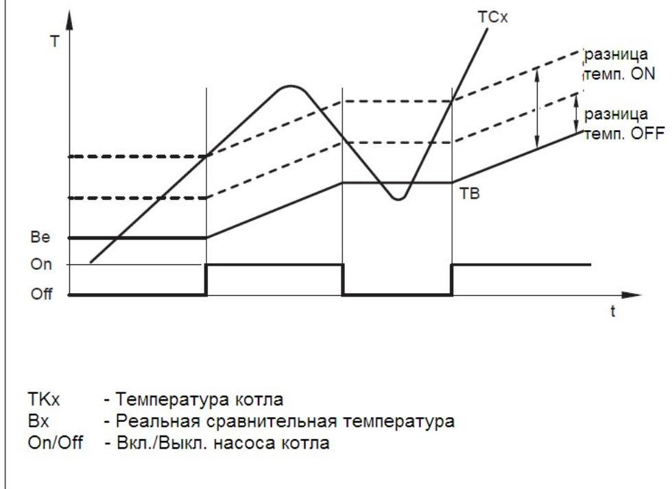
Для поддержания сравнительной температуры, могут быть использованы следующие настройки в прог. № 4133:
