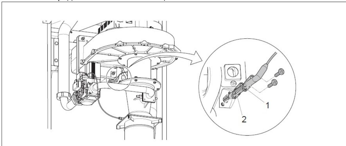
3. Отсоединить провод зажигания на преобразователе зажигания
