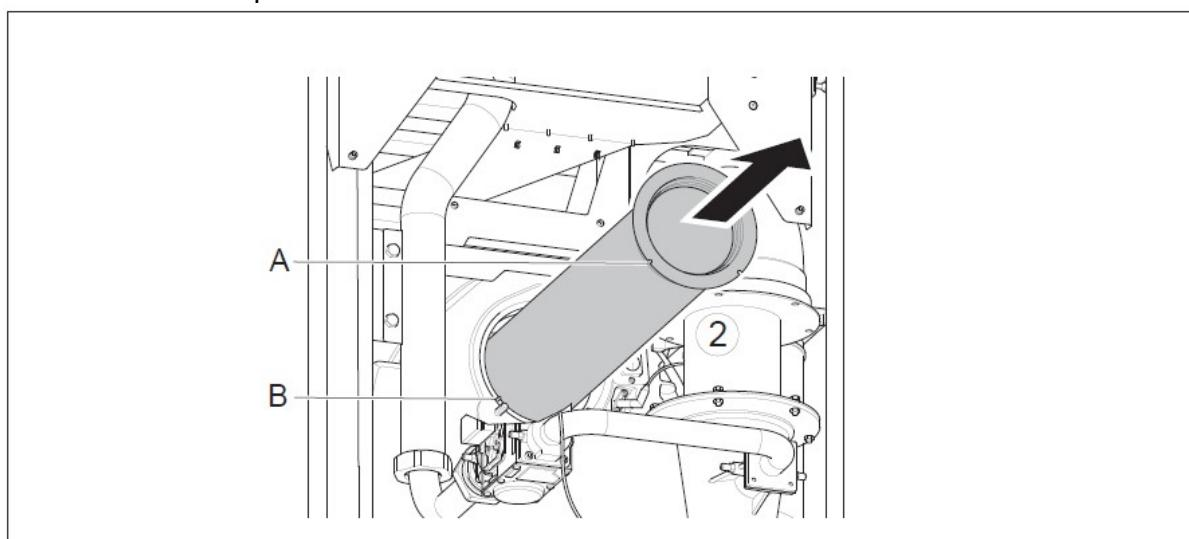
5. Извлечь сопло горелки из отверстия (2)
