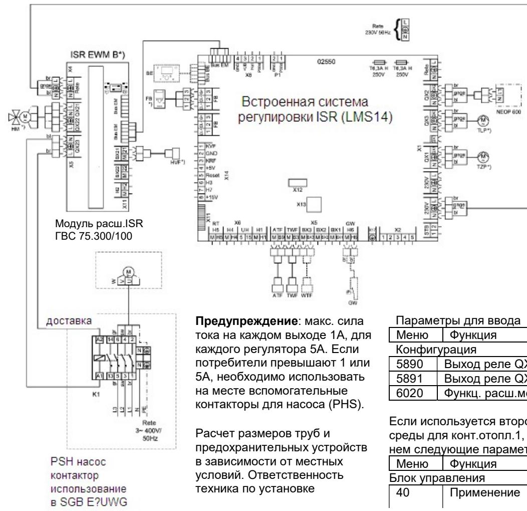
Пример применения 3. Power HT-A с 3 контурами смешанного отопления, гидравлическим сепаратором и производством ГВС
