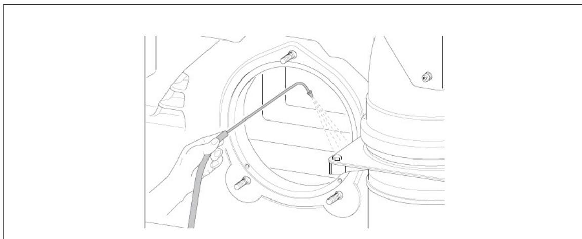
7. Через отверстие горелки сбрызнуть внутреннюю поверхность теплообменника водой с моющим средством для газовых котлов.
