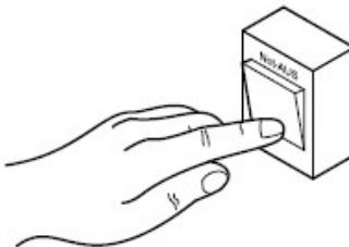
Нажать общий аварийный выключатель.
