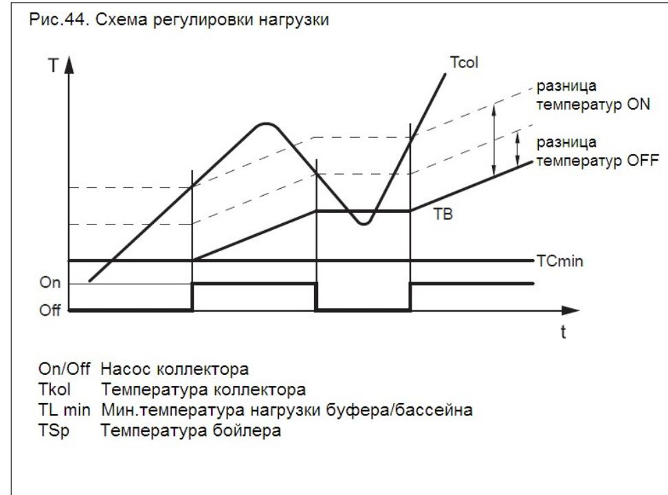
**Миним. температура нагрузки ГВС (3812)** Кроме разницы температур, для включения бойлера необходимо достичь определенной минимальной температуры коллектора.
