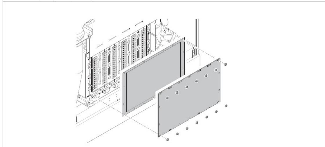
3. Ослабить гайки и снять смотровую крышку с прокладкой
